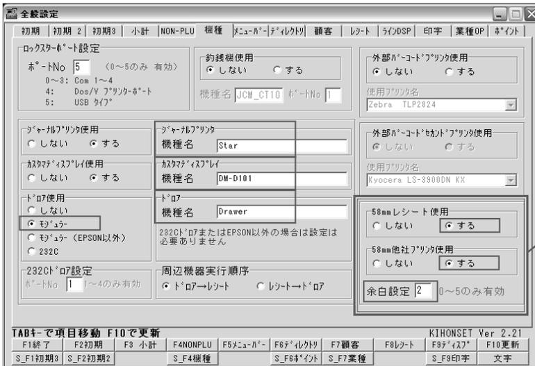
58mm 幅のレシートを使用する場合は図のように設定します。
