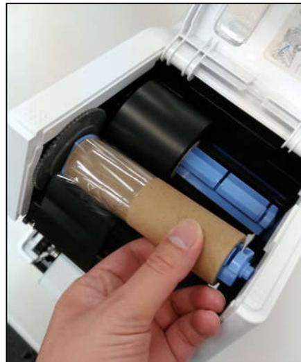
ボトムリボンカバー側からリボン巻取りコアを引き出して手前に取り付けます。
