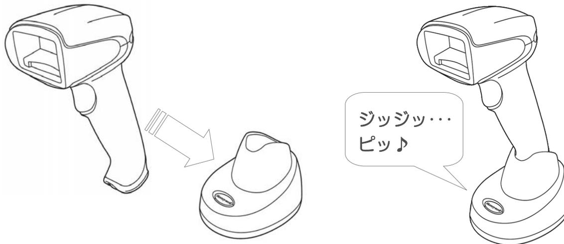
※初期設定の設定バーコードを読み取り後、ホームベースの乗せてもペアリングを行わない場合はクレードルの後面に貼られているバーコードを読み取り、ホームベースに乗せて下さい。
