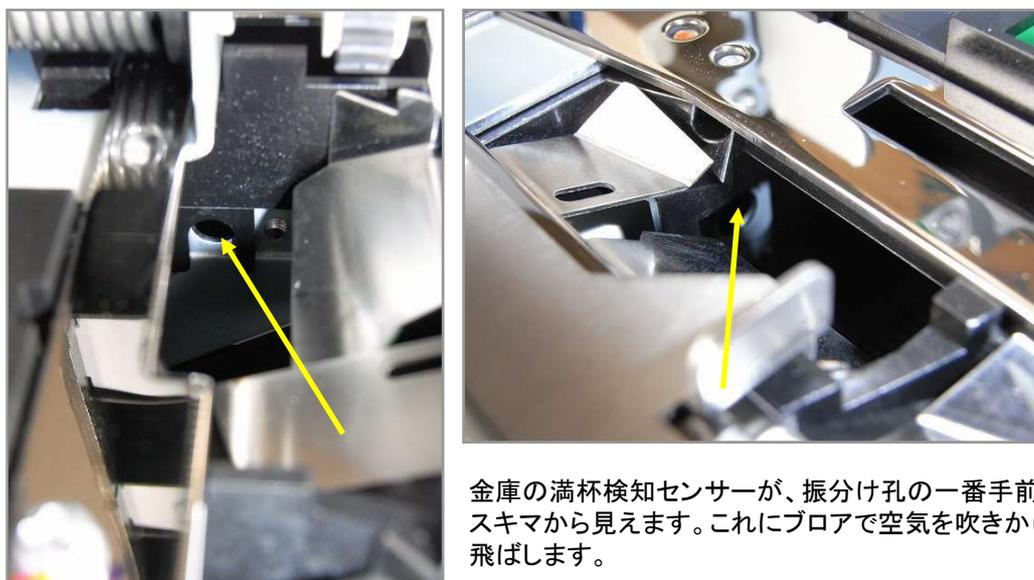
金庫の満杯検知センサーが、振分け孔の一番手前と一番奥のスキマから見えます。これにブローで空気を吹きかけ、ホコリを飛ばします。
