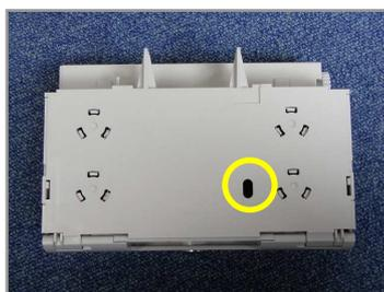
回収庫の両脇、及び天地に開いている穴の詰まりをブローで吹き飛ばします。
