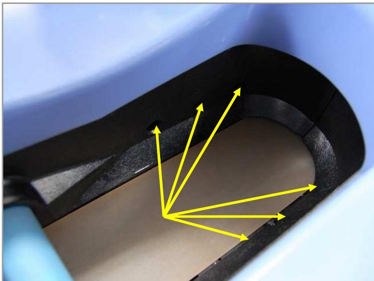
ブロアを使って6箇所のセンサーに空気を吹きかけ、ホコリを飛ばします。
