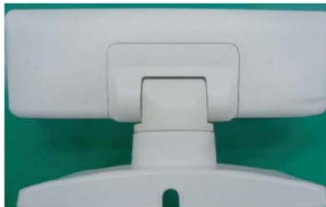
1 0) ヒンジ組品を表示部、設置台にビス(2本)を取り付け、アース線を表示部にビスで取り付ける。
